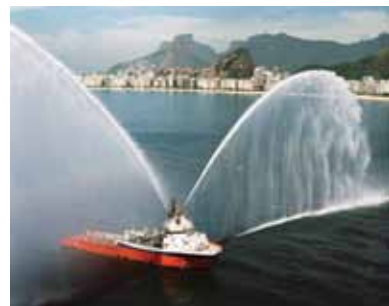
Navio de apoio marítimo com sistema de combate a incêndio
