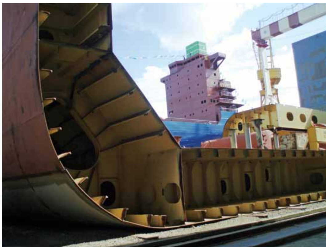
Anel do bloco de aço estrutural para construção do navio
