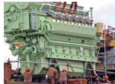
Motor marítimo de porte médio, dois motores em cada navio de apoio marítimo
