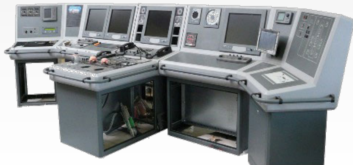
Centro de comando elétrico de uma plataforma
