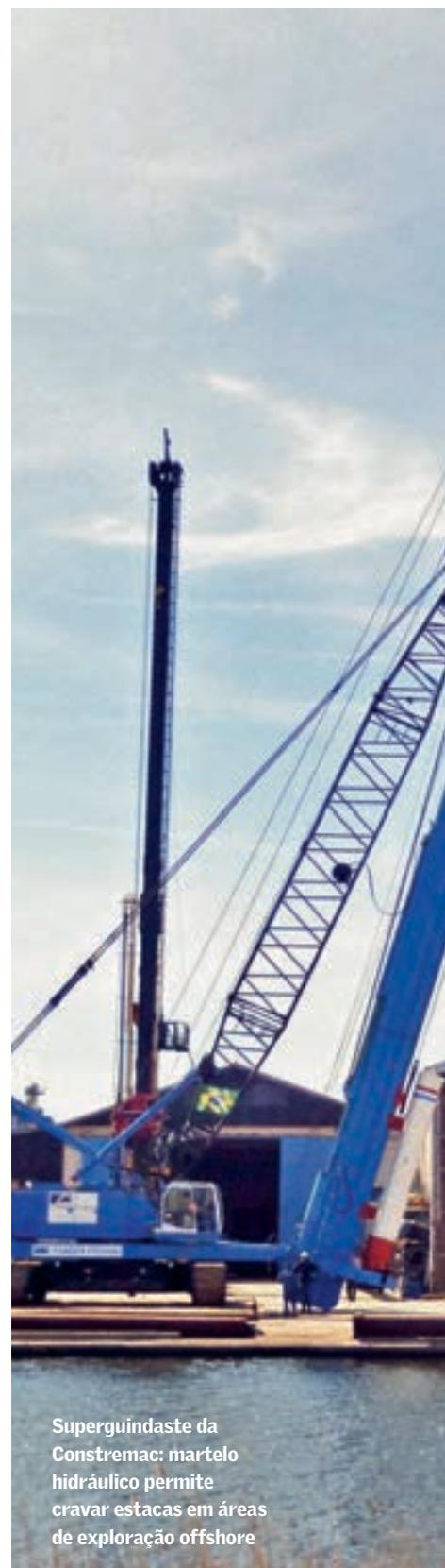
Superguindaste da Constremac: martelo hidráulico permite cravar estacas em áreas de exploração offshore
